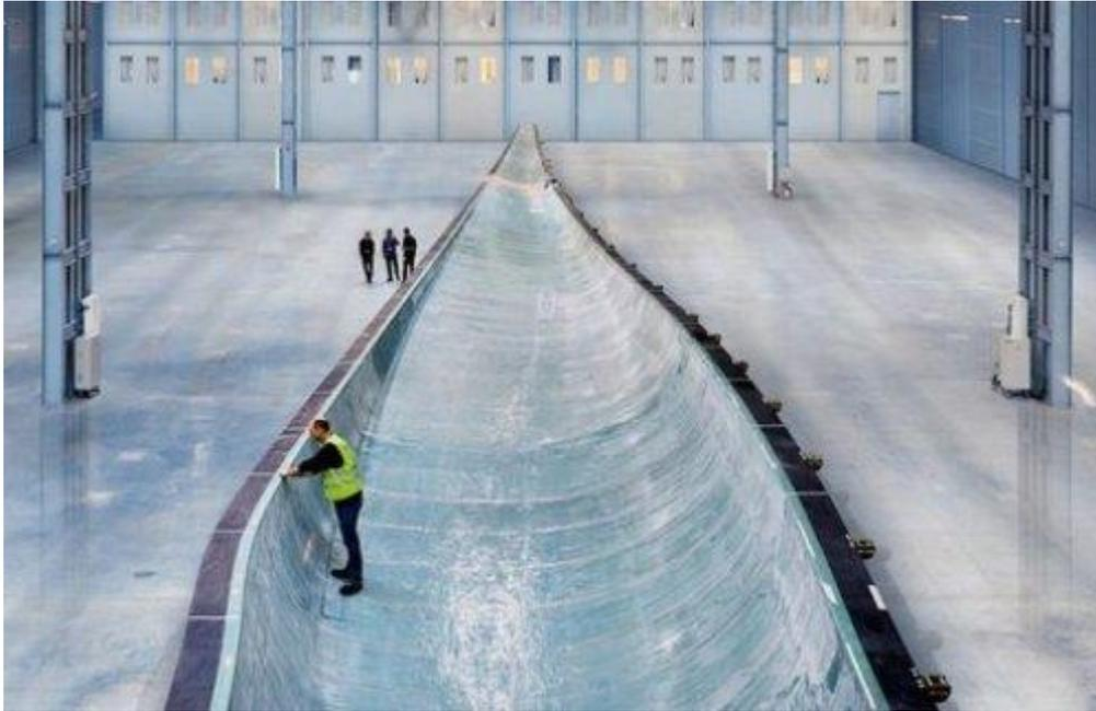
El SWT-6.0-154, de Siemens, tendrá una hoja de 75 metros de largo que trabajará junto con una turbina de 6 MW. Las aspas se construyen con un nuevo proceso de fabricación llamado IntegralBlade.
