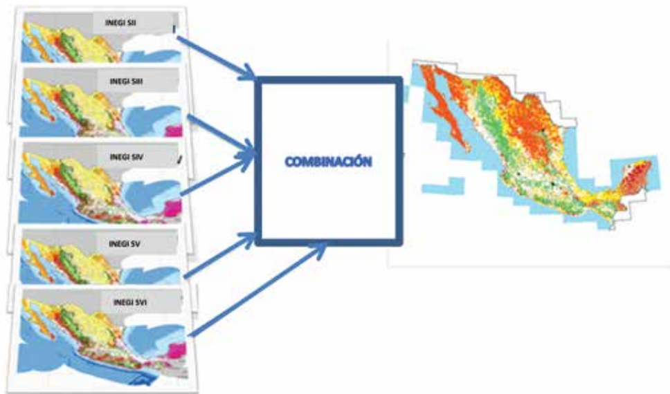
Figura 3. Modelo cartográfico para combinación de datos de tramado ( raster )
